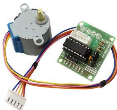
Рис. 20. Шаговый двигатель 28BYJ-48
