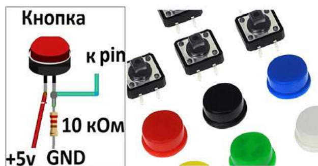
Рис. 1. Схема подключения тактовой кнопки к микроконтроллерной плате
